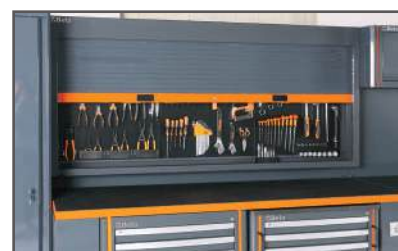
Persiana de alumínio, ajustável verticalmente, com trava
